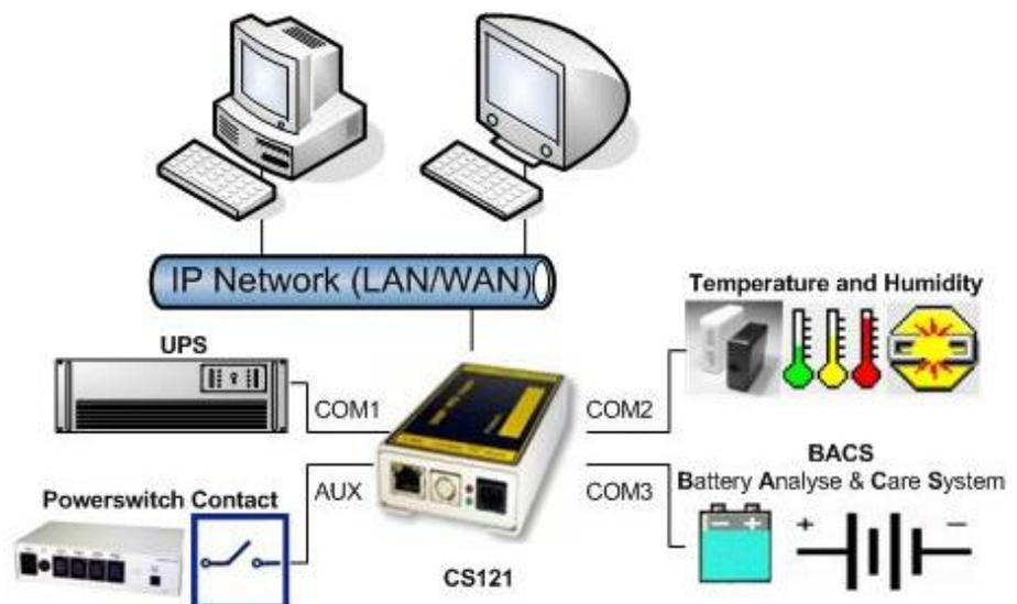
CS121 (nicht Budget) Modelle nach 04/2007 sind mit einem erweiterten AUX-Port („COM3“) ausgestattet, der den Anschluß von **BACS** (**B**attery **A**nalyse & **C**are **S**ystem) an den CS121 ermöglicht.
